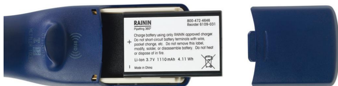
Figure 5 : Installation de la batterie principale
