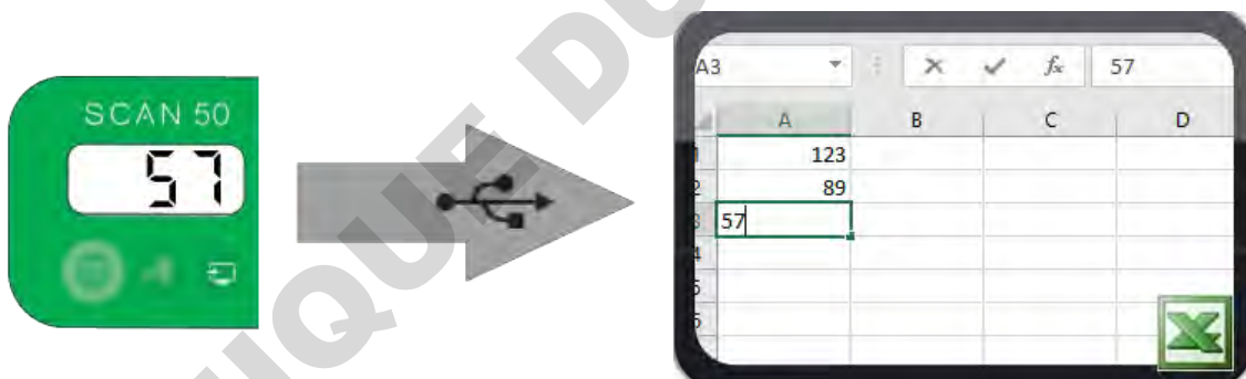
Figure 7 : Envoi par liaison USB du résultat de comptage dans un fichier Excel
