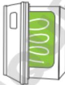
La lampe à UV se déclenche automatiquement pendant 90 minutes après un cycle de vaporisation de H<sub>2</sub>O<sub>2</sub> de sept minutes, puis décompose la vapeur en eau et en oxygène.
