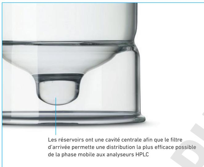
Les réservoirs ont une cavité centrale afin que le filtre d'arrivée permette une distribution la plus efficace possible de la phase mobile aux analyseurs HPLC
