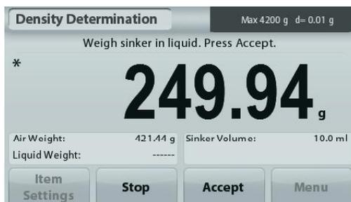
Une fois que les poids nécessaires ont été déterminés, la densité de l'échantillon liquide est affichée en  $\text{g/cm}^3$  (conjointement au poids dans l'air, au poids dans l'eau) sur l'écran Application.
