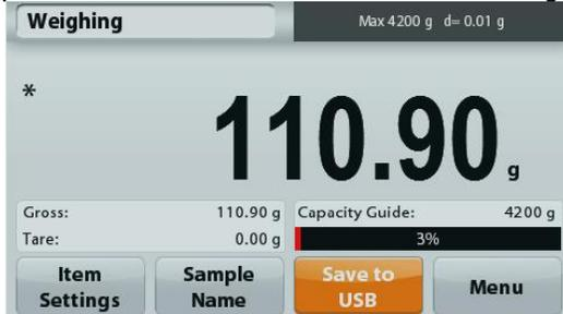
**Remarques :** Lors de la première connexion sur la balance d'une clé USB, un léger retard peut se produire avant que le bouton **Enregistrer vers USB** ne fonctionne. Ceci est dû au fait que la balance génère les dossiers nécessaires sur l'emplacement de stockage des données de la clé USB.
