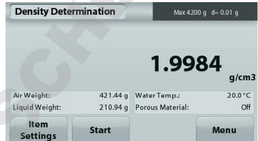
Une fois que les poids nécessaires ont été déterminés, la densité de l'échantillon liquide est affichée en **g/cm<sup>3</sup>** (conjointement au poids dans l'air, et au poids dans l'eau) sur l'écran Application.
