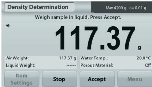
**Étape 2 sur 2 - Pesée de l'échantillon submergé dans un liquide.**
