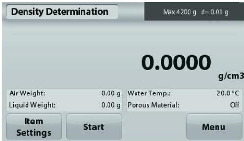
**Étape 1 sur 2 - Pesée de l'échantillon dans l'air.**
