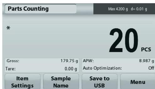
**Optimisation automatique :** Si réglée sur **Marche**, elle améliore la précision du comptage en recalculant le poids des pièces au fur et à mesure de l'ajout d'autres pièces. Par défaut sur **Arrêt**.
