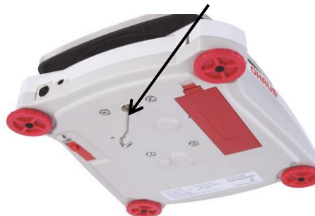
Pesata Sotto il Gancio installato
