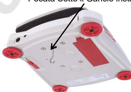
Pesata Sotto il Gancio installato
