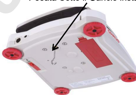
Pesata Sotto il Gancio installato
