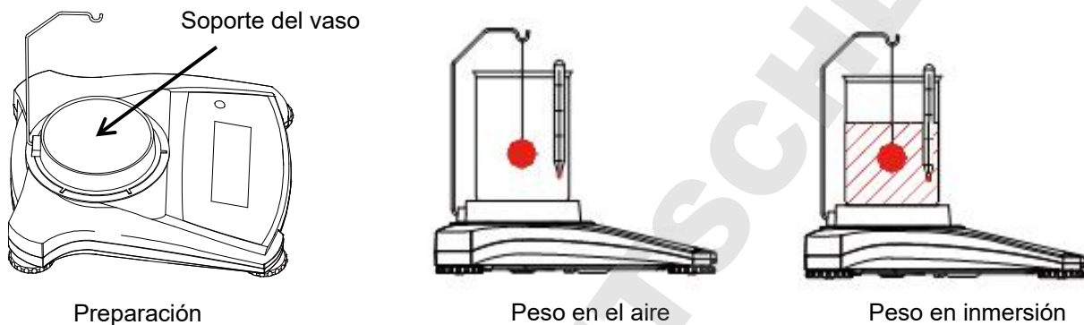
Gráfico 3-3. Configuración para la medición de densidad
