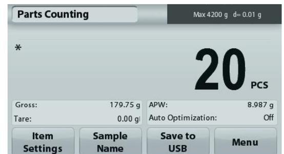
**Optimisation automatique :** Si réglée sur **Marche**, elle améliore la précision du comptage en recalculant le poids des pièces au fur et à mesure de l'ajout d'autres pièces. Par défaut sur **Arrêt**.
