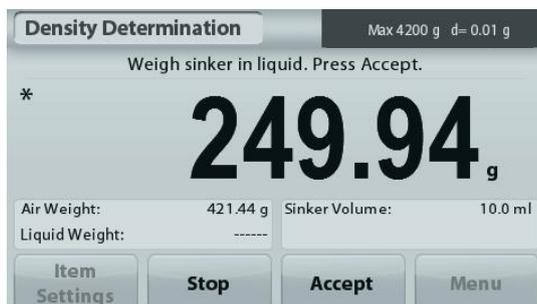
Une fois que les poids nécessaires ont été déterminés, la densité de l'échantillon liquide est affichée en **g/cm<sup>3</sup>** (conjointement au poids dans l'air, au poids dans l'eau) sur l'écran Application.
