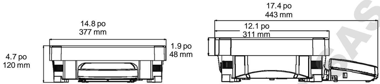
Figure 9-4. Modèles EX12001, EX24001 et EX35001
