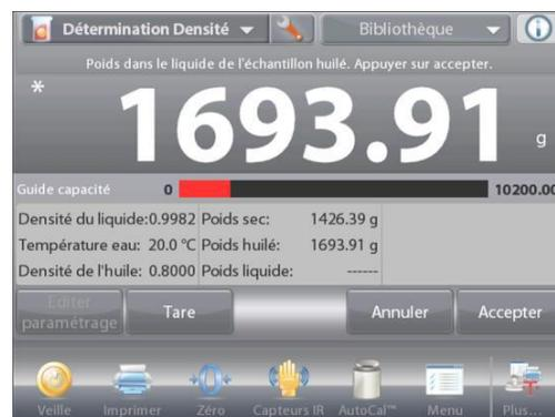
Une fois que les poids nécessaires ont été déterminés, la densité de l'échantillon est affichée en **g/cm<sup>3</sup>** (conjointement au poids dans l'air, avec et sans huile, et au poids dans l'eau) sur l'écran application.
