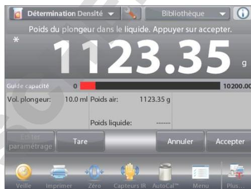
Une fois que les poids nécessaires ont été déterminés, la densité de l'échantillon liquide est affichée en **g/cm<sup>3</sup>** (conjointement au poids dans l'air, au poids dans l'eau) sur l'écran application.
