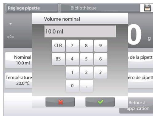
Pour régler la température de l'eau, appuyer sur le bouton **Température de l'eau**.
