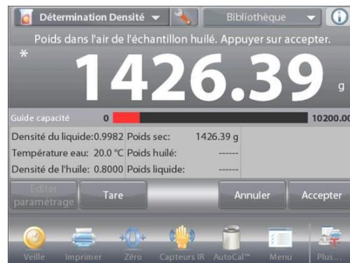
**Étape 3 sur 3 - Pesée de l'échantillon huilé submergé dans un liquide.**
