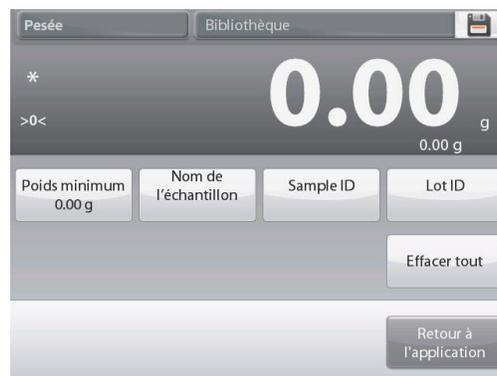
Si un poids réel est inférieur à la valeur **Minimum Weight** (poids minimum) établie, l'écran affichera **Below Minimum Weight** (en dessous du poids minimum).
