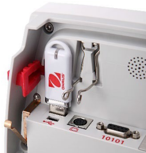
Connexions de l'interface à l'arrière du terminal.
