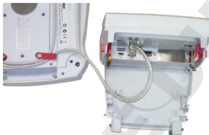
Câble du terminal
