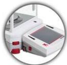
Appuyer sur le bouton pour séparer le terminal de la base. Faire reposer les extrémités des crochets du panneau sur la base. Faire osciller le panneau à la position verticale.
