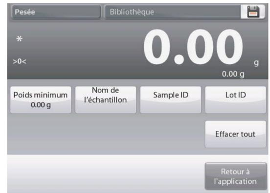
Si un poids réel est inférieur à la valeur **Minimum Weight** (poids minimum) établie, l'écran affichera **Below Minimum Weight** (en dessous du poids minimum).
