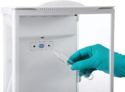
Le purificateur d'air génère continuellement des ions bipolaires au moyen de décharges par effet couronne, séparément à partir d'électrodes de décharge positives et négatives, et dirige l'air ionisé dans le corps chargé afin d'éliminer l'électricité statique. Les ions générés présentent une polarité bien équilibrée et peuvent éliminer l'électricité statique, quelle que soit la polarité du corps chargé.
