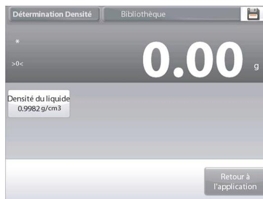
Mesurer la densité réelle du liquide de la configuration de la densité et l'introduire.
