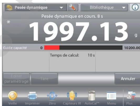
À la fin du cycle, retirer l'échantillon et la balance reviendra automatiquement à l'écran d'accueil (après un délai de 10 secondes).
