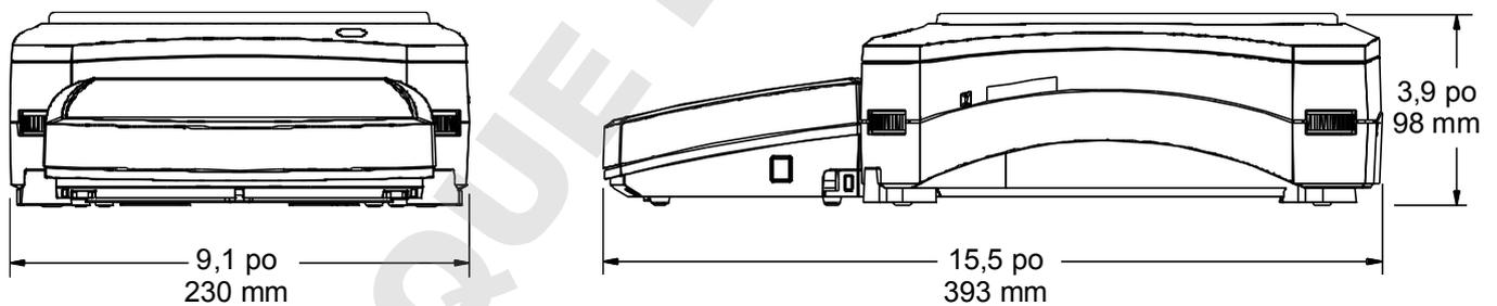
Figure 9-2 Modèles sans pare-vent
