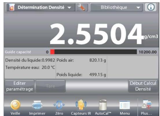
Une fois que les poids nécessaires ont été déterminés, la densité de l'échantillon est affichée en **g/cm<sup>3</sup>** (conjointement au poids dans l'air, et au poids dans l'eau) sur l'écran application.
