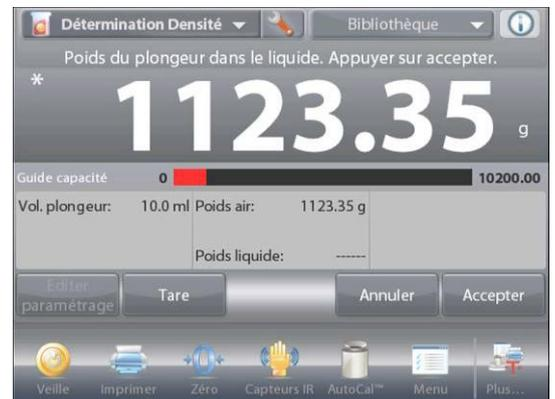
Une fois que les poids nécessaires ont été déterminés, la densité de l'échantillon liquide est affichée en **g/cm<sup>3</sup>** (conjointement au poids dans l'air, au poids dans l'eau) sur l'écran application.
