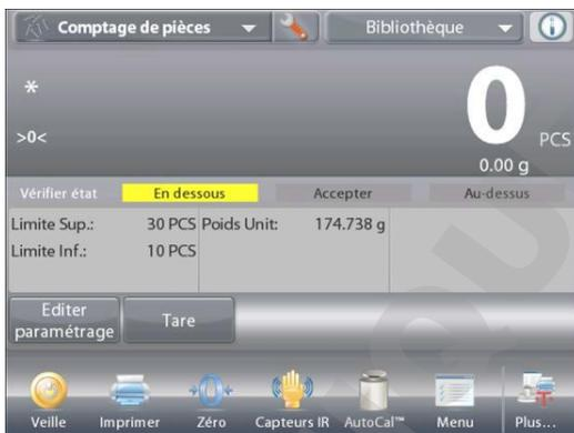
Appuyer sur le bouton Paramétrage (clé) pour entrer dans le menu Paramétrage du comptage.
