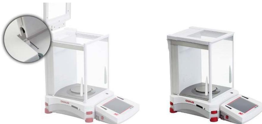
Insérer les extrémités des crochets de la porte supérieure dans les ancrages rainurés. Appuyer légèrement pour bien les placer. Vérifier la facilité du déplacement. Fermer la porte.
