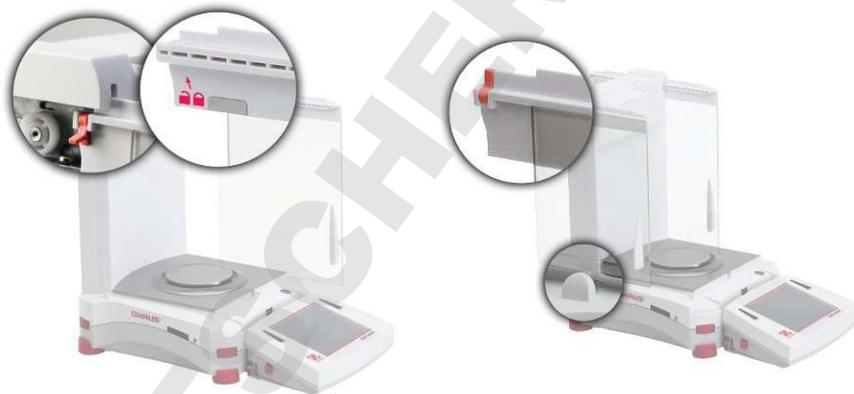
Positionner la porte en verre pour qu'elle coulisse. Ouvrir la languette de verrouillage (supérieure) ; insérer dans la rainure supérieure et faire coulisser au fond de la rainure inférieure. Fermer la languette de verrouillage.
