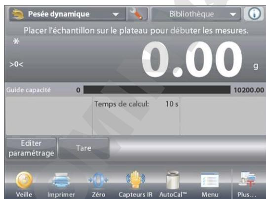
Placer un échantillon sur le plateau. Le cycle démarre automatiquement.
