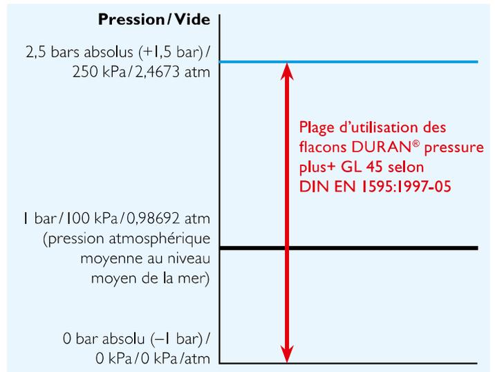
Remarque : En cas de sollicitation sous pression : résistance aux chocs thermiques 30 k et température maximale en utilisation +140 °C.
