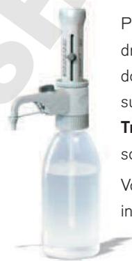
Pour le dosage d'acide fluorhydrique (HF), nous recommandons le distributeur adaptable sur flacon **Dispensette® S**
