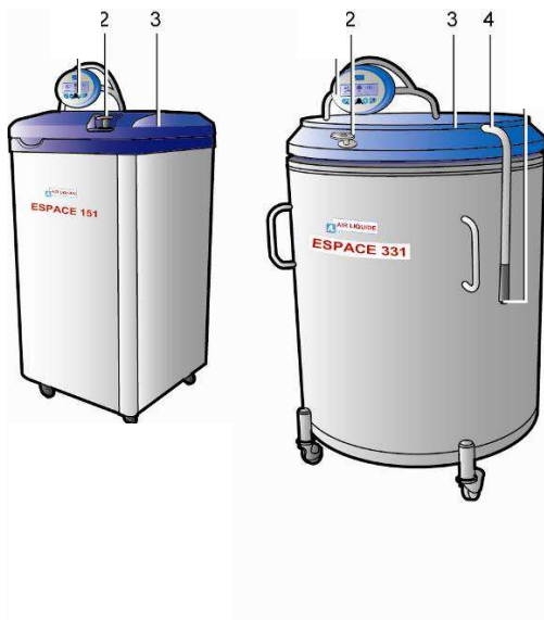
Figure 3-2 : vue générale d'un réservoir cryogénique de type ESPACE 151 (gauche) et 331 ou 661 (droite).
