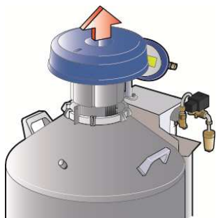
Figure 8-8 : ouverture ou fermeture du bouchon
