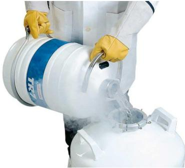
Figure 8-1 : remplissage à partir d'un récipient TR ; étape 1.
