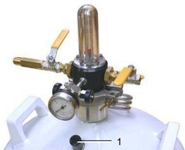
8. Fermer la vanne de remplissage (rep. 1). Retirer le flexible du TP et de la vanne de ligne (ou du ravitailleur) (rep. 4). Fermer la vanne de mise à l'air libre (rep. 2) dès qu'elle ne dégage plus.
