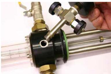
3. Appliquer du ruban PTFE ou de la pâte d'étanchéité (silicone, etc.) sur les filets de la pièce de rechange, en prenant soin de ne pas obstruer les orifices.
