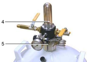
3. Extraire la tête de commande (rep. 4) du réservoir en la soulevant et la déposer sur un support adapté.
