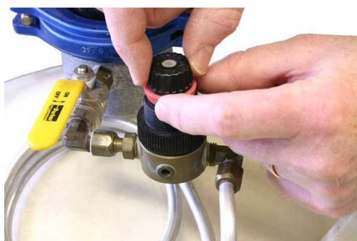
Figure 9-2 : Bague de verrouillage rouge du régulateur.
