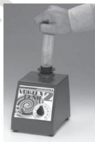
1.0 - Branchez le cordon dans une prise à trois broches correctement mise à la terre (120 VCA pour le modèle G560, 230 VCA pour le modèle G560E et 100 V pour le modèle G560-100V ) .
