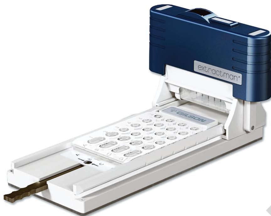
EXTRACTMAN® est une plateforme d'extraction par billes magnétiques, basée sur une technologie innovante pour isoler des protéines et complexes protéiques même faiblement liés, et habituellement éliminés lors du lavage.
