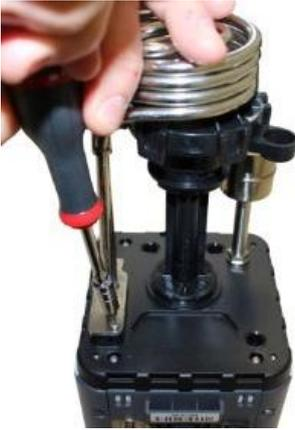
Démonter la résistance chauffante du thermostat (Torx : 2,5 mm).
