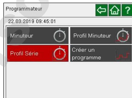
À la fin d'un profil, l'appareil passe dans un mode final qu'il est possible de sélectionner et de définir.
