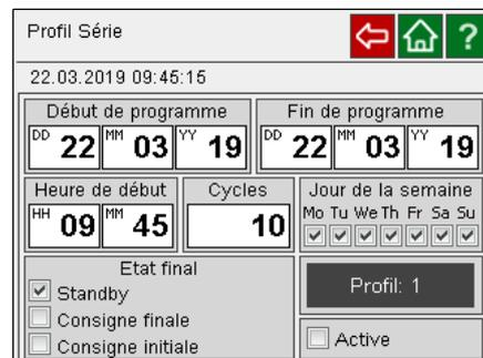
Les profils peuvent être supprimés en les sélectionnant
