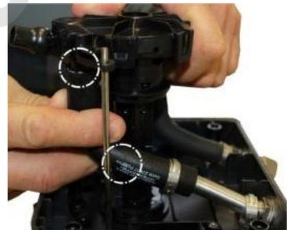
Enficher le tuyau jusqu'à l'arrêt sur les manchons de la pompe. Inscription "*PUMP*>>..." en direction des manchons de la pompe.
