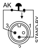
Sortie d'alarme pour un signal d'alarme externe.
