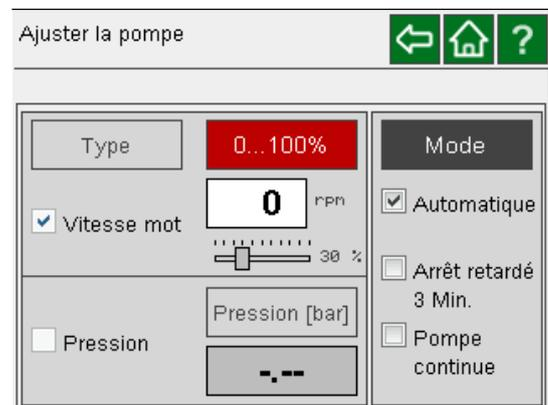
Le débit de la pompe est réglable via la vitesse du moteur ou par le réglage de la pression. La pompe est indépendante de ces éléments :
