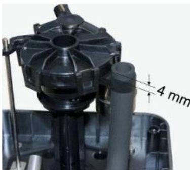
Introduire l'extrémité du tuyau côté >IN< dans le support de la pompe jusqu'à obtenir un dépassement de 4 mm.
