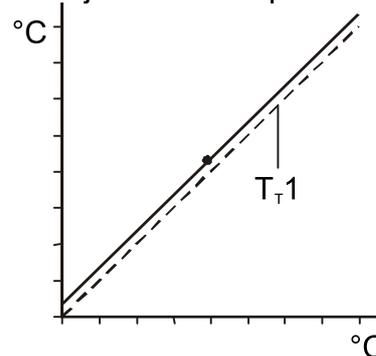
Lors de l'ajustement à 3 points, une courbe incurvée peut apparaître. Cela permet d'améliorer la précision de l'affichage thermique dans la plage thermique qui est déterminante pour l'application.
