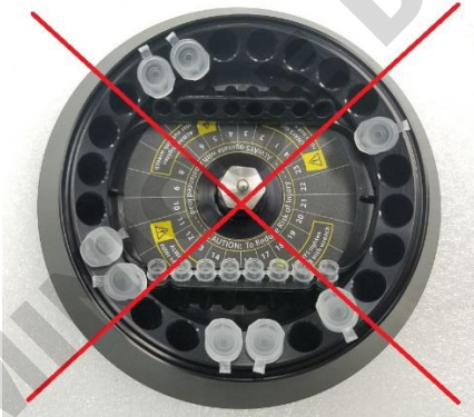
Figure 1. Chargement du rotor pour atteindre l'équilibre
