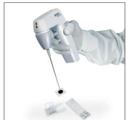
Avec la **pince à vide** il est très facile de manipuler les lamelles ou autres petits objets fragiles. Appuyez simplement sur les boutons de pipetage du PIPETBOY pour attraper facilement et placer exactement des objets jusqu'à 50 g.
