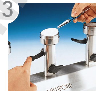
3 Soulever la membrane pour la retirer facilement du support après filtration
