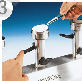
3 Soulever la membrane pour la retirer facilement du support après filtration
