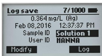
HI 83326 peut mémoriser jusqu'à 1000 mesures photométriques et pH associées. À la mise en mémoire, l'utilisateur est invité à identifier l'échantillon et l'opérateur à l'aide du clavier alphanumérique. Les mesures enregistrées sont automatiquement complétées avec les données BPL (date, heure, valeurs des standards).
