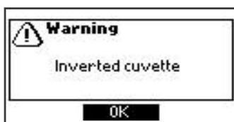
*Cuvettes inversées* : La cuvette échantillon et la cuvette zéro ont été inversées.
