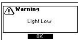
*Lumière faible* : L'instrument ne peut pas ajuster le niveau de la lumière. Vérifiez que l'échantillon ne contienne pas de débris.
