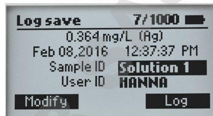
HI83305 peut mémoriser jusqu'à 1000 mesures photométriques et pH associées. À la mise en mémoire, l'utilisateur est invité à identifier l'échantillon et l'opérateur à l'aide du clavier alphanumérique. Les mesures enregistrées sont automatiquement complétées avec les données BPL (date, heure, valeurs des standards).
