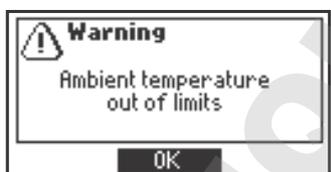
*Température ambiante hors limites* : L'instrument est trop chaud ou trop froid pour réaliser une mesure précise. Attendez que l'instrument atteigne une température comprise entre 10 et 40 °C avant de réaliser une mesure.
