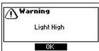
*Lumière forte* : Il y a trop de lumière pour réaliser une mesure. Vérifiez la préparation de la cuvette zéro.
