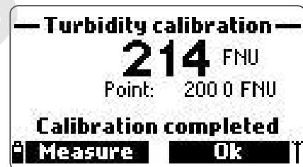
**Note :** la procédure d'étalonnage peut être quittée après le 1er ou le 2ème point par simple appui de la touche <ESC>. Un étalonnage en 1 point est recommandé uniquement pour rafraîchir la valeur d'Offset d'un étalonnage en 2 ou 3 points précédent. Un étalonnage en 2 points est uniquement recommandé lorsque la valeur attendue est inférieure à 40 FNU.
