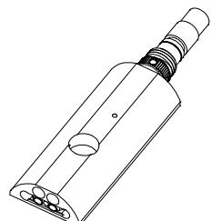
**HI 7609829-4** : sonde combinée de conductivité et de turbidité. Elle inclue une sonde de conductivité 4 anodes ainsi qu'un capteur de turbidité conforme à la norme ISO 7027. Le capteur de turbidité utilise une technique optique pour mesurer les matières en suspension dans l'eau.
