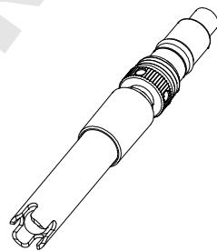
**HI 7609829-1** électrode combinée pH/ORP avec bulbe en verre sensible aux ions H<sup>+</sup> pour la mesure du pH et un capteur platine pour la mesure du rédox. Référence double Ag/AgCl avec électrolyte gélifié.
