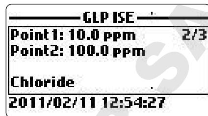
**Notes** Si aucun étalonnage ISE n'a été réalisé ou si les données d'étalonnage ont été effacées à l'aide de la fonction "Restore factory calib." les valeurs d'Offset et de pente sont à leur valeur par défaut. Le message "Factory calibration" est affiché. Appuyez sur <ESC> pour retourner à l'écran précédent.
