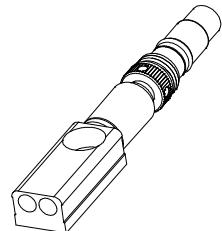
**HI 7609829-3** : sonde de conductivité 4 anodes. Ce type de sonde est totalement insensible aux effets de polarisation.
