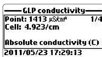
**Notes** une lettre "C" derrière la valeur standard indique l'utilisation d'une solution standard personnelle et l'indication "H" indique l'utilisation d'une solution HANNA INSTRUMENTS. Si aucun étalonnage de conductivité n'a été réalisé ou si l'étalonnage a été effacé à l'aide de l'option "Restore factory calib." les valeurs de Pente et d'Offset par défaut seront utilisées pour les mesures et un message "Factory calibration" est affiché. Appuyez sur <ESC> pour retourner à l'écran précédent.
