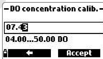
Placez le capteur et la sonde de température dans cette concentration connue.
