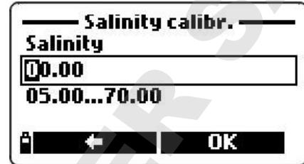
**Notes** Ces procédures réalisent l'étalonnage de la pente. Pour réaliser un étalonnage de l'OFFSET, il est nécessaire de réaliser un étalonnage à 0 µS/cm. Si la valeur de la température n'est pas comprise dans une fourchette acceptable (0 à 50°C), un message "Invalid temperature" est affiché.
