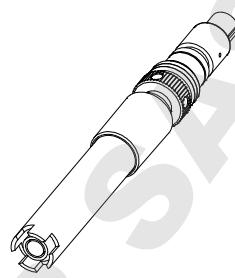
**HI 7609829-11:** électrode sélective pour la mesure des chlorures libres dans les eaux fraîches. Le capteur utilise une pilule de chlorure d'argent logée dans un corps PEI ainsi qu'une électrode de référence double jonction Ag/AgCl et un électrolyte gélifié. Ce capteur est utilisé en lieu et place de l'électrode de pH.
