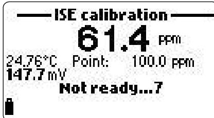
Plongez le capteur ISE ainsi que la sonde de température dans cette 2ème solution.
