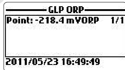
**Notes** si aucun étalonnage ORP n'a été réalisé ou si l'étalonnage a été effacé par l'option "Restore factory calib.", les valeurs d'Offset et de pente par défaut seront utilisées pour les mesures et un message "Factory calibration" est affiché. Appuyez sur <ESC> pour retourner à l'écran précédent.
