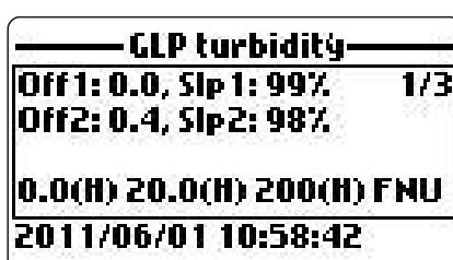
**Notes** si aucun étalonnage de turbidité n'a été réalisé ou si le dernier étalonnage a été effacé par "Restore factory calib.", les valeurs d'Offset et de Pente seront prises par défaut et un message "Factory calibration" est affiché. Appuyez sur <ESC> pour retourner à l'écran précédent.
