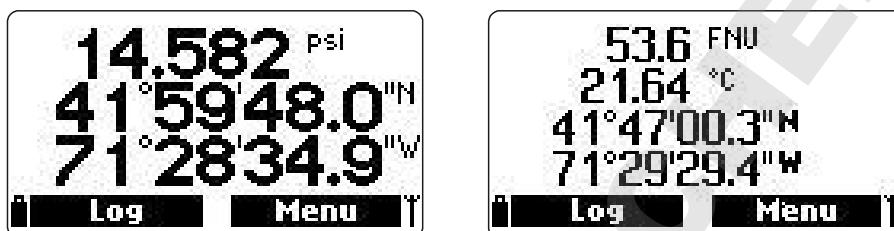
affichée en permanence à l'aide d'une antenne à 3 niveaux dans le coin supérieur droit de l'afficheur. Si l'antenne est clignotante, la réception n'est pas complète ou le signal n'est pas assez puissant. La réception du signal peut être améliorée en allant au dehors ou en évitant de se trouver à côté d'arbres ou de véhicules.
