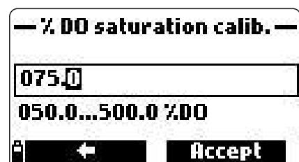
**Note** L'étalonnage peut être réalisé en 1 point en appuyant sur <ESC> lorsque le 1er point a été accepté.
