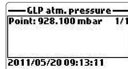
**Notes** si aucun étalonnage de la pression atmosphérique n'a été réalisé ou si les données d'étalonnage ont été effacées par l'option "Restore factory calib." la valeur d'Offset sera prise par défaut et un message "Factory calibration" est affiché. Appuyez sur <ESC> pour retourner à l'écran précédent.
