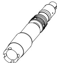
**Note** les capteurs d'oxygène dissous ont besoin d'être activés avant installation. Pour ceci, voir la section 4.2.3.
