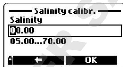
**Notes** Ces procédures réalisent l'étalonnage de la pente. Pour réaliser un étalonnage de l'OFFSET, il est nécessaire de réaliser un étalonnage à 0  $\mu\text{S}/\text{cm}$ . Si la valeur de la température n'est pas comprise dans une fourchette acceptable (0 à 50°C), un message "Invalid temperature" est affiché.
