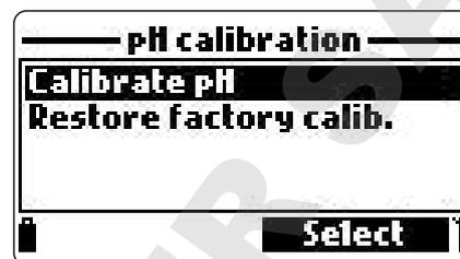
Si un nouveau capteur de pH a été mis en place, utilisez "Restore Factory Calib" avant de réaliser un étalonnage, car certains messages d'erreurs dépendent des opérations d'étalonnage précédentes.
