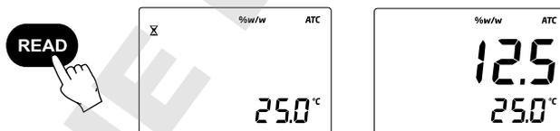
**Note :** l'icône ATC clignotera et la compensation de température ne se fera pas si la température de l'échantillon est en dehors de la gamme 10-40 °C.
