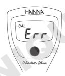
En mode étalonnage, si l'instrument affiche un message "Err" lorsque l'électrode est dans une solution étalon fraîche, alors l'électrode doit être nettoyée. Placer l'électrode dans la solution de nettoyage HI700601 pendant 15 minutes. Rincer à l'eau pure et mettre à tremper dans HI 70300 pendant une heure avant d'étalonner. Si le message d'erreur "Err" persiste l'électrode HI 1271 doit être remplacée.
