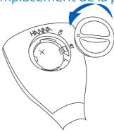
Pour remplacer la pile Li-ion CR2032, tourner le courvecle du compartiment à pile, à l'arriere de l'instrument, dans le sens anti-horaire pour le débloquer. Retirer le couvercle et remplacer la pile, polarité + vers le dessus.
