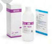
La solution tampon pH 10,01 est une solution d'étalonnage dite technique, attestant d'une exactitude  $\pm 0$ ,01 pH à 25 °C. Les solutions techniques sont plus économiques et répondent amplement aux attentes de précision de la plupart des applications.
