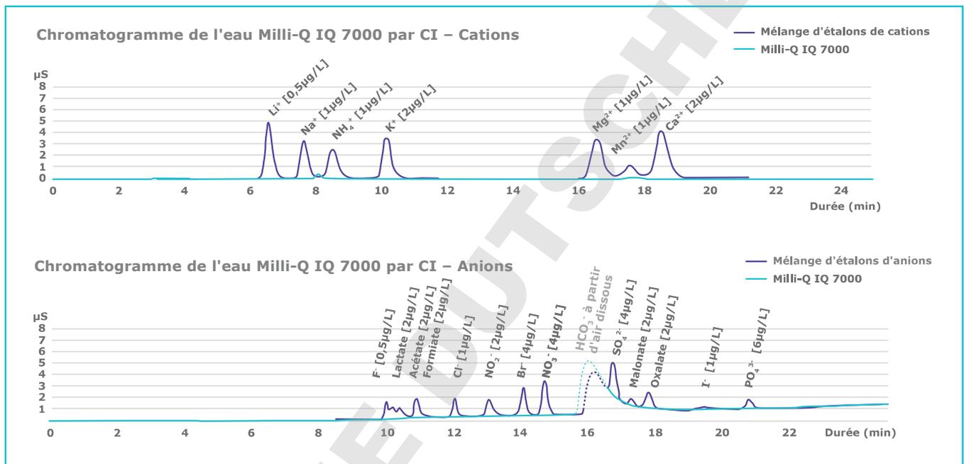
Milli-Q IQ 7000 fournit également de l'eau ultra pure à faible COT (Carbone Oxydable Total). Les meilleurs résultats (inférieurs à 2 ppb) sont obtenus avec une
