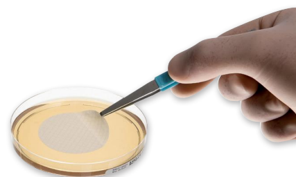
Le support de drainage donne sa forme à la membrane pour garantir un contact parfait avec le milieu de culture et un recouvrement optimal des micro-organismes
