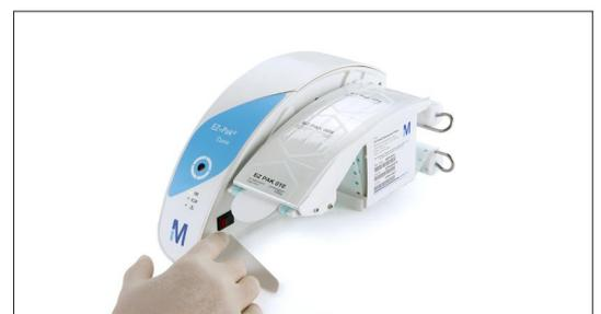
**4** Mettre sous tension, la première membrane est distribuée lorsque le capteur est activé
