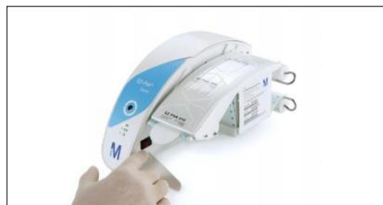
**4** Mettre sous tension, la première membrane est distribuée lorsque le capteur est activé
