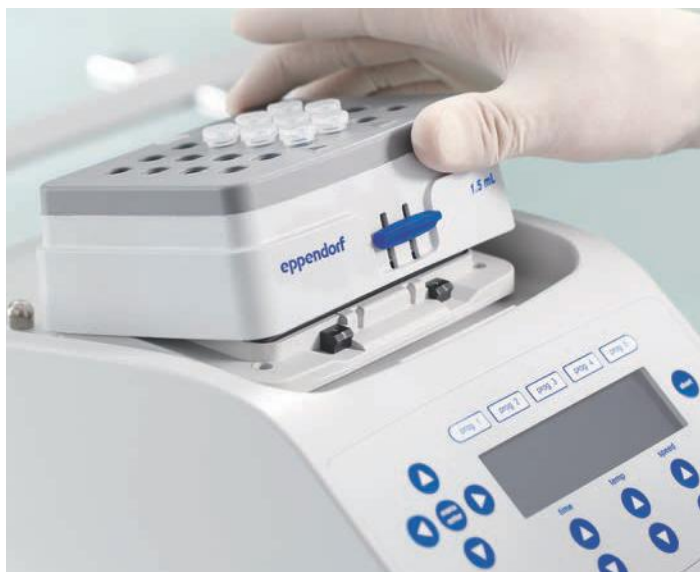
Retrait du SmartBlock de l'Eppendorf ThermoMixer® C
