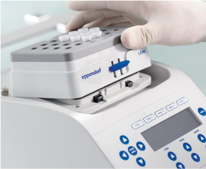
Retrait du SmartBlock de l'Eppendorf ThermoMixer® C
