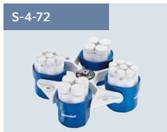
Rotor libre 4 x 250 mL. Vitesse max. 3 234 x g (4 200 rpm).
