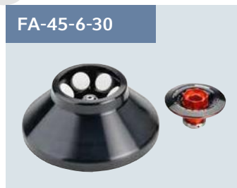
Rotor pour 6 x tubes coniques de 50 mL avec couvercle anti-aérosols QuickLock, pour tubes de 5 à 50 mL. Vitesse max. 16 639 x g (11 000 rpm).
