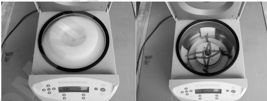
5. Si le rotor fait partie des pièces incluses dans la livraison, desserrer ce dernier et le retirer à l'aide de la clé de rotor fournie.
