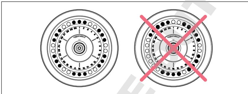
Afin de minimiser les différences de poids entre les tubes remplis d'échantillons, il est conseillé de les tarer avec une balance. Cela permet de protéger l'entraînement et de réduire le bruit de fonctionnement.
