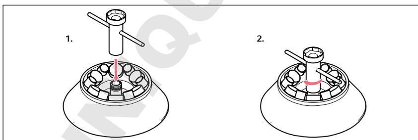
1. Mettre le dispositif de prélèvement en place avec le côté étroit sur le filetage du rotor.
