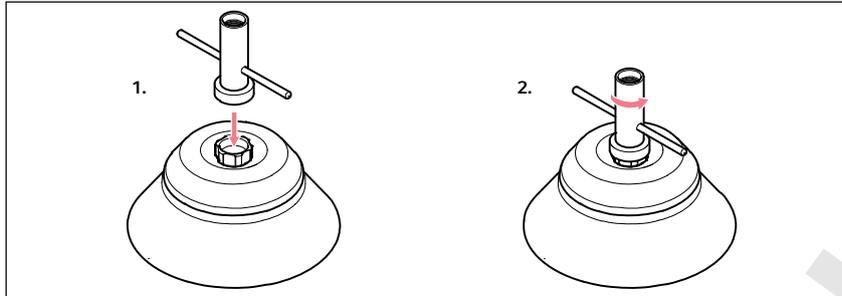
1. Mettre le dispositif de prélèvement en place avec le côté large sur la vis de couvercle de rotor.
