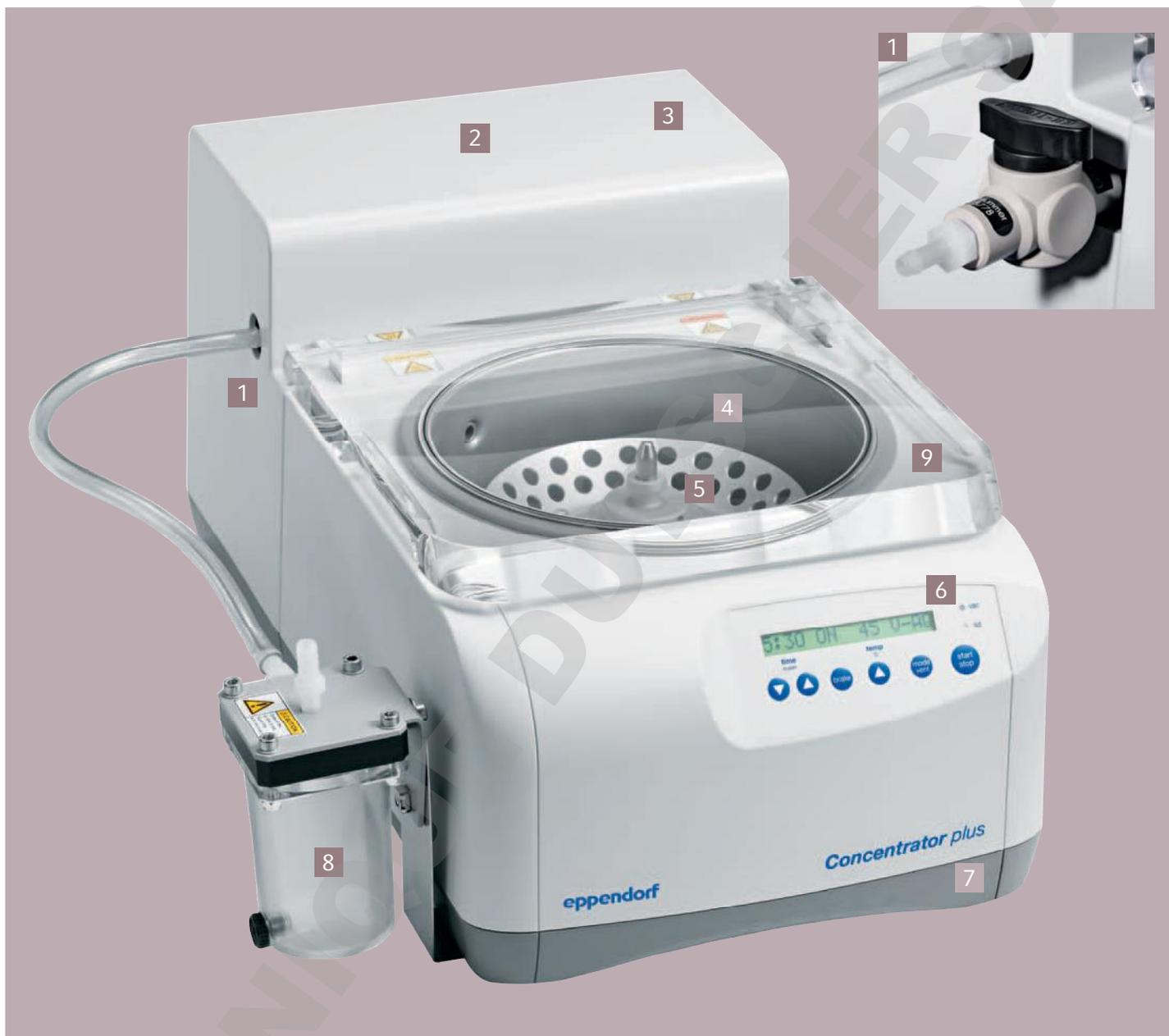
**1** Connexion au vide en option pour une plus grande fiabilité. Permet de raccorder des appareils externes à la pompe à vide.
