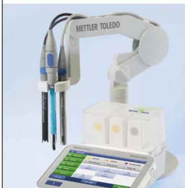
uPlace™ : actionnable d'une main, le bras d'électrode se déplace parfaitement à la verticale vers le haut/bas pour amener l'électrode à la position idéale. Les mesures gagnent en rapidité et les risques de renverser le contenu de l'échantillon ou d'endommager la sonde sont réduits !
