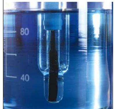
Nach dem Anschliessen eines beliebigen InLab ISM-Sensors (Intelligent Sensor Management) erkennt das Instrument diesen automatisch und speichert dessen Sensor-ID und die letzten Kalibrierdaten. Somit wird der Zeitaufwand gesenkt und durch die Sensorerkennung das Fehlerisiko reduziert.
