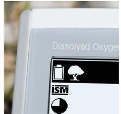
Der zusätzlich zu den Labormodi verfügbare Modus für Aussenbereiche bietet dem Bediener Geräteeinstellungen (z. B. Ruhemodus für die Bildschirmhelligkeit und automatisches Ausschalten), sodass die AA-Batterien noch seltener gewechselt werden müssen.
